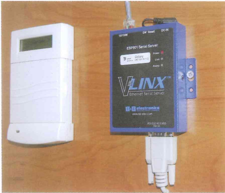
Seriële ethernetserver geschikt voor een beveiligingsinstallatie.
